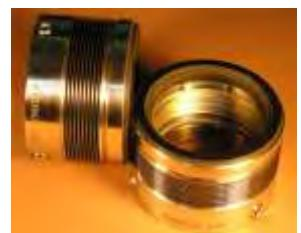
Mehanički zaptiva sa metalnim mehom
