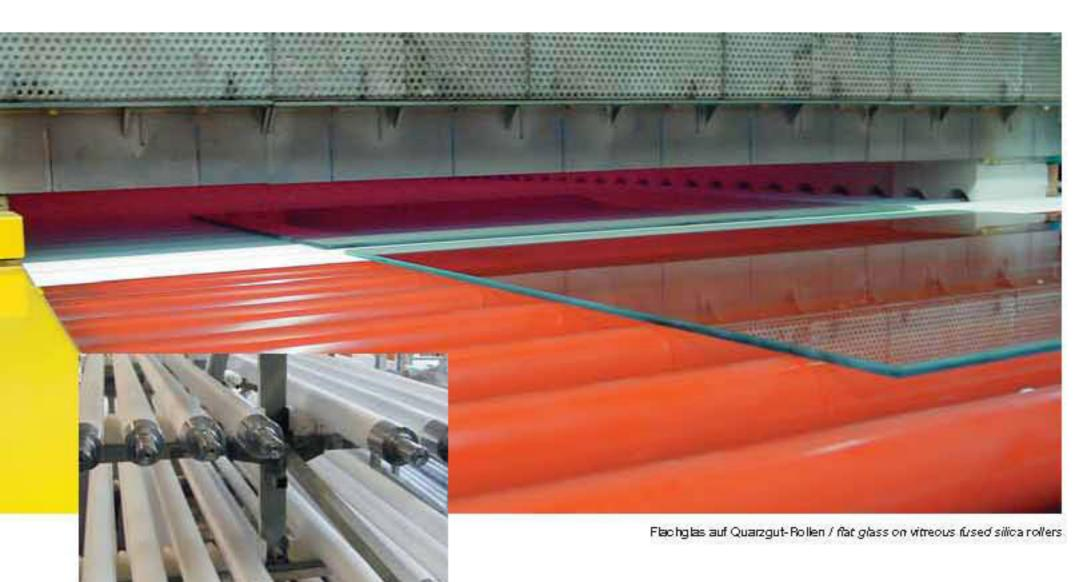
Quarzgut-Rollen dienen speziell als Transportrollen zum Tempern von Flachglas. Das Verfahren wird bereits seit vielen Jahren zur Herstellung von Sicherheitsflachglas angewandt. Dieses wird hauptsächlich als Architekturglas verwendet, z.B. für Schaufensterglas, Fassadenverkleidung, Glastüren usw. Auch im Fahrzeugbau wird Sicherheitsglas eingesetzt.
